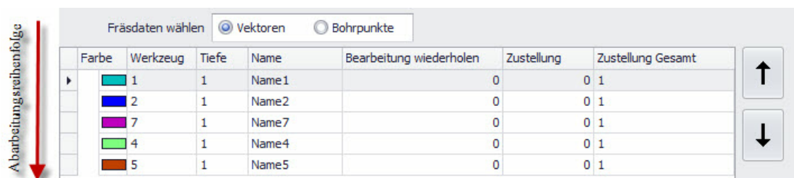
Ilustracja 3: Opcja "zmień narzędzie" jest aktywna. Kolejność obróbki można zmienić poprzez wybór narzędzia w liście i uruchomienie przycisku ze strzałkami (w górę lub w dół).
